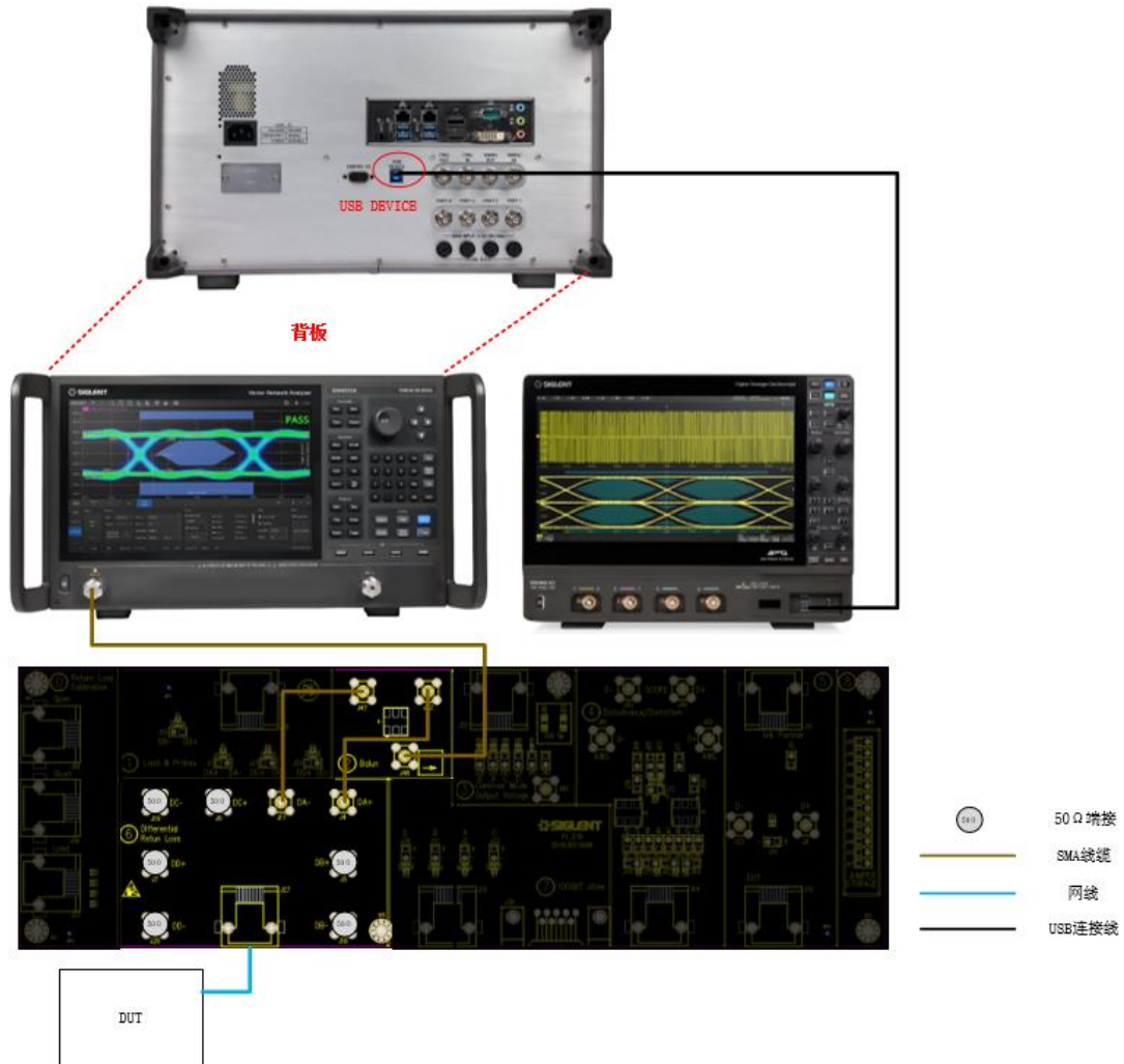
图 6-18 发送器回波损耗测试环境
