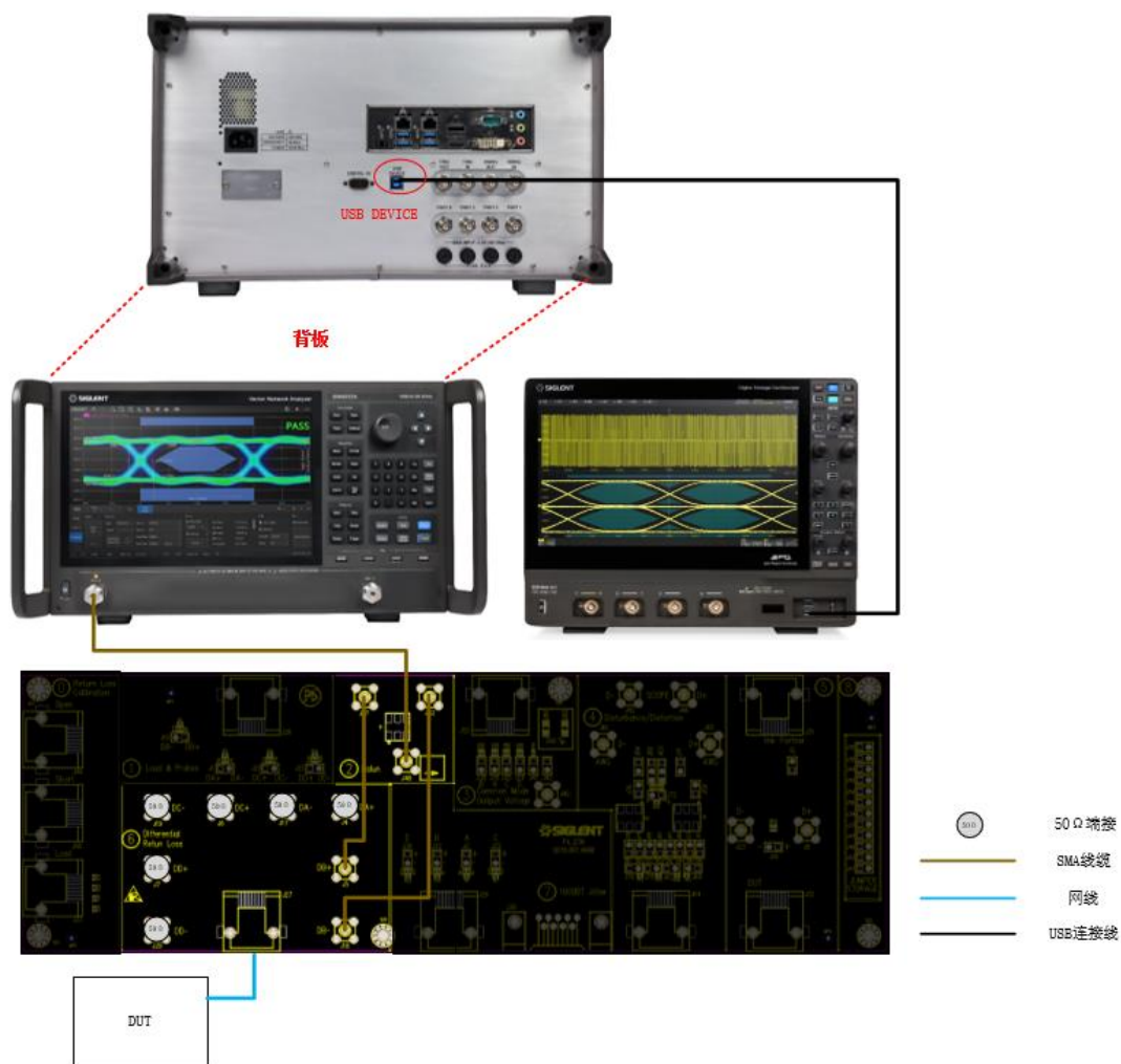
图 6-22 接收器的回波损耗测试环境
